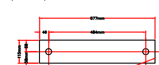
ALÇA DE ICAMENTO BARR. Ø16mm(A36) (VER DETALHE)
